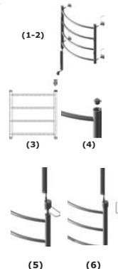
7. Нанесите разметку на стене, в месте установки электрического полотенцесушителя, для телескопических креплений. Для удобства нанесения разметки, предварительно накрутите телескопические крепления на электрический полотенцесушитель.
